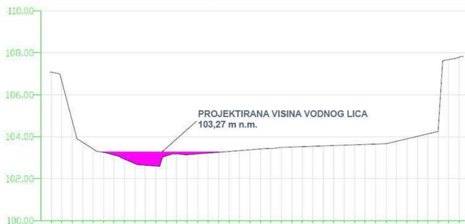
Slika 2.4 Shematski prikaz presjeka i pogled na pregradu na lokaciji varijante 1 (Izvor: Idejno rješenje)
